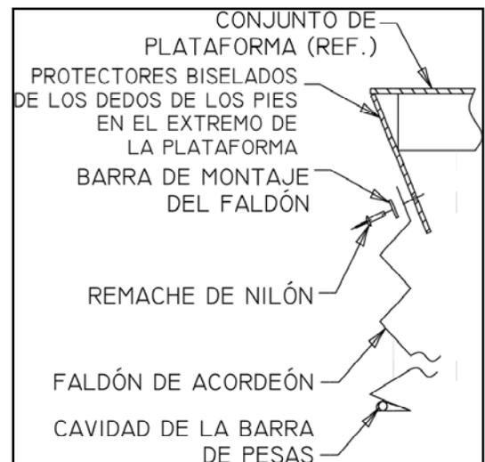
4. Instale las barras de pesas en las cavidades de las barras de pesas en la parte inferior del faldón de acordeón. Instale las barras de alambre templadas de resorte en la cavidad de circunconvoluciones negras.
